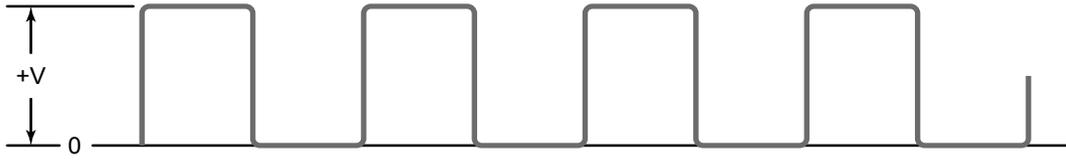
**FIGURE 3.8 - FREQUENCY OUTPUT WAVEFORM (SQUARE WAVE)**
