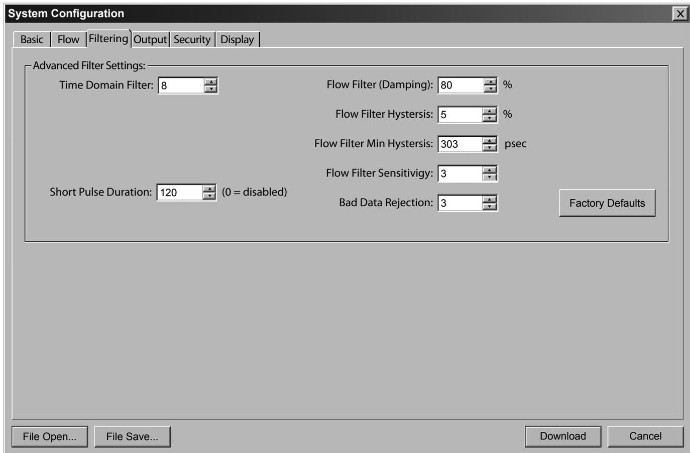
**FIGURE 5.4 - FILTERING TAB**
