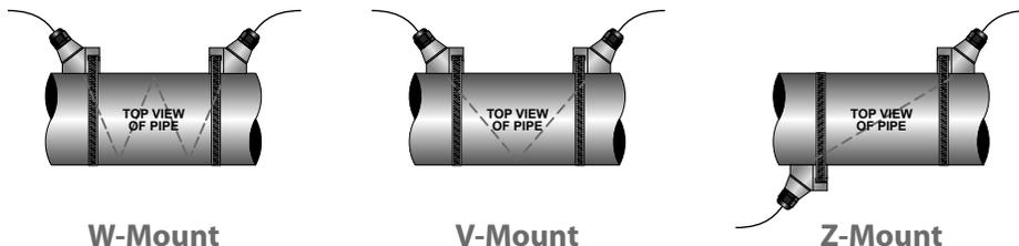
**FIGURE 1.1 - ULTRASOUND TRANSMISSION**
