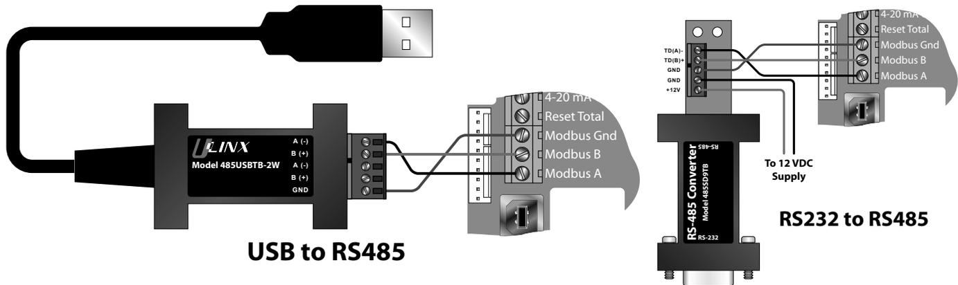
**FIGURE 3.9 - RS485 NETWORK CONNECTIONS**
